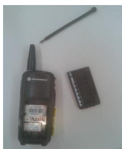
Figura 12 - Ht quebrado por queda
